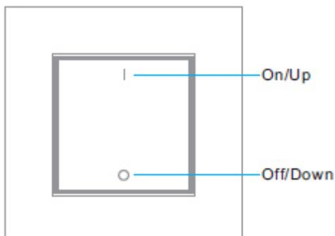
1. Verbindung aufbauen: Den „learning key“ beim Sys-One Sequenzer drücken und dann eine Taste beim WandController drücken. Das rote LED Licht blinkt auf: die Verbindung war erfolgreich.
